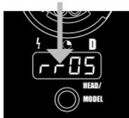
6. Wählen Sie den Funkkanal, indem Sie die Leistungskontrolle D [13] drehen, bis der gewünschte Kanal in der Leistungsanzeige D [10] angezeigt wird, z.B. Kanal 05 wie in der Figur oben.
