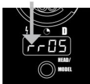
5. Stellen Sie den Generator auf Synchronisation über Funk ein, indem Sie die Kopf/Einstelllichttaste D [12] drücken, bis "r" an der zweiten Stelle der Leistungsanzeige D [10] angezeigt wird, siehe Abbildung unten. (Wenn "-" gewählt wird, ist die Synchronisation über Funk nicht aktiviert).
